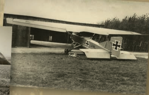
Samolot Junkers J.I był pierwszym całkowicie metalowym samolotem bojowym
